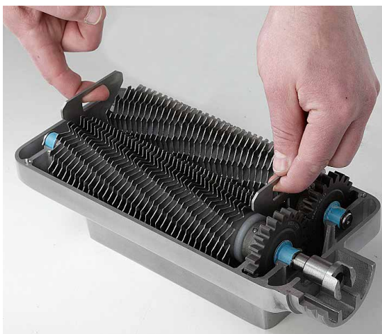
Rys. 9 Demontaż zespołu wałków
