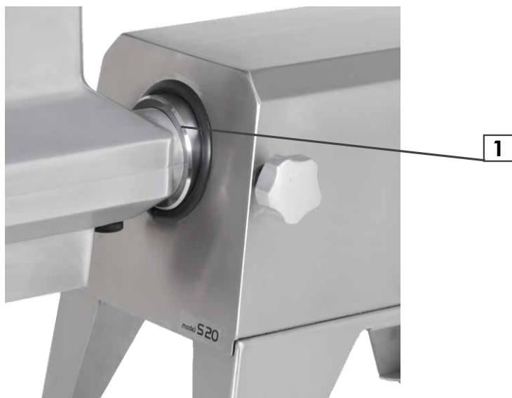
Rys. 6. Prawidłowo zamontowany moduł stekera w jednostce napędowej.
