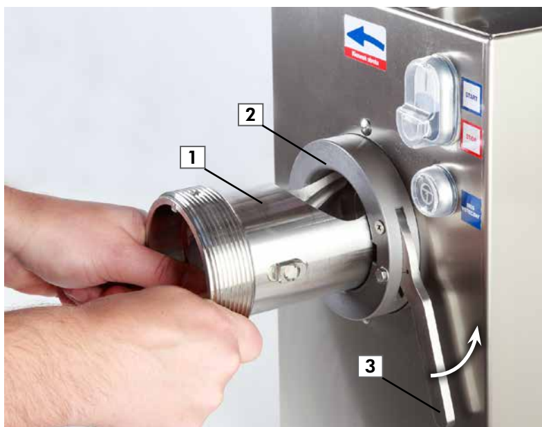
Rys. 7. Prawidłowe zamontowanie obudowy ślimaka w jednostce napędowej.
